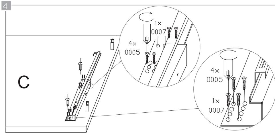
Ubique uno de los rieles del cajón inferior (0007) en el sitio indicado, de manera tal que sus orificios coincidan con los del tablero de la pieza. Fije en su posición insertando 8 tornillos de 12 mm. (0005) en los sitios indicados. Verifique que los dos rieles se mueven de manera fluida y sin obstáculos y que todos los elementos se encuentran en su posición.
