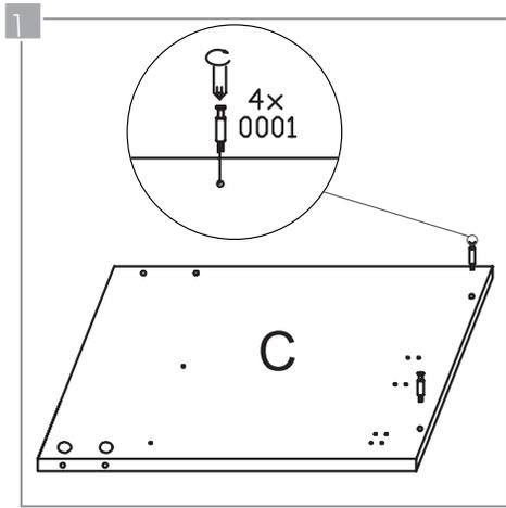
Ubique uno de los paneles laterales (C) sobre una mesa de trabajo, de manera tal que la cara con orificios quede hacia arriba. Inserte cuatro tornillos planos de 30 mm. (0001) en los sitios indicados con un destornillador de estría. Gírelos hasta obtener un ajuste uniforme, pero no excesivo.
