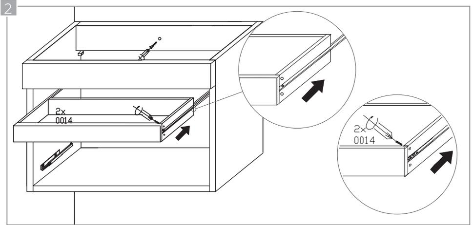
Extienda los dos rieles de guía del cajón (0013) e insértelos en los acanalados exteriores del cajón interior. Fíjelos en su posición insertando dos tornillos de 10 mm. (0014) en los orificios correspondientes. Verifique la fluidez en los movimientos de apertura y cierre.
