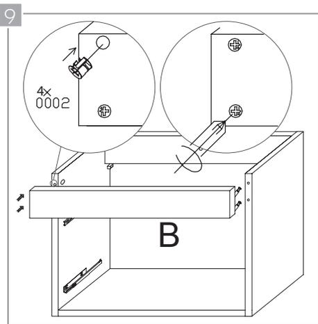
Inserte los tornillos fijados en el panel frontal (B) en los orificios ubicados en los cantos de los paneles laterales (C). Inserte dos tensores a cada lado, de manera que queden a tope con la madera. Gírelos ¼ de vuelta con un destornillador de estría. Verifique que todo el conjunto quede firme.
