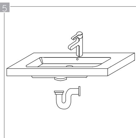
5 Instale el lavamanos en el mueble lavamanos de forma correcta de los cajones de su mueble. Conecte los sifones del lavamanos y de la pared utilizando un desagüe flexible. Instálelo siguiendo las instrucciones del fabricante.
