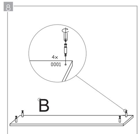
Ubique el panel frontal (B) sobre una superficie plana e inserte cuatro tornillos planos de 30 mm. (0001) en los sitios indicados. Gire con un destornillador de estría hasta obtener un ajuste uniforme.
