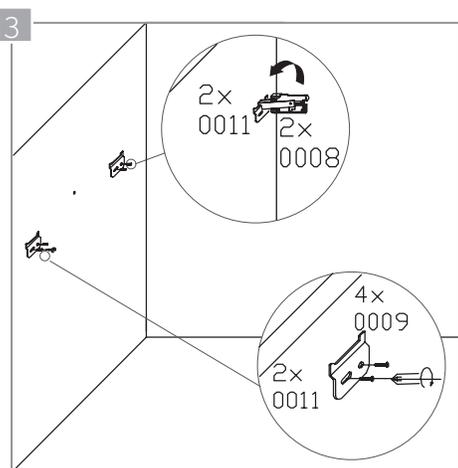
Fije los dos anclajes de pared (0011) con cuatro tornillos de 40 mm. (0009). Verifique con un nivel que estén correctamente alineadas, y que tengan un ajuste firme y sin oscilaciones.
