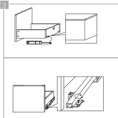
Extienda los dos rieles de guía del cajón (0007) e insértelos en los acanalados la gaveta exterior. Fíjelo en su posición empujando hacia adentro los pestillos correspondientes. Regule la velocidad y tensión de apertura y cierre girando hacia la derecha o la izquierda el tornillo indicado en la gráfica.
