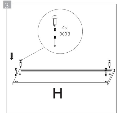
Ubique el panel posterior del cajón exterior (H) sobre una superficie plana y coloque 4 tornillos planos de 25 mm. (0003) en los sitios indicados. Gire con un tornillo de estría hasta obtener un ajuste firme, pero no excesivo.
