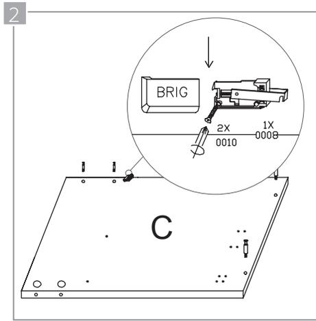
Tome una de las abrazaderas a pared (0008), desmonte su cobertura exterior y ubíquela en el sitio indicado con dos tornillos de 22 mm. (0010). La muesca de la abrazadera debe apuntar en el mismo sentido de la flecha.
