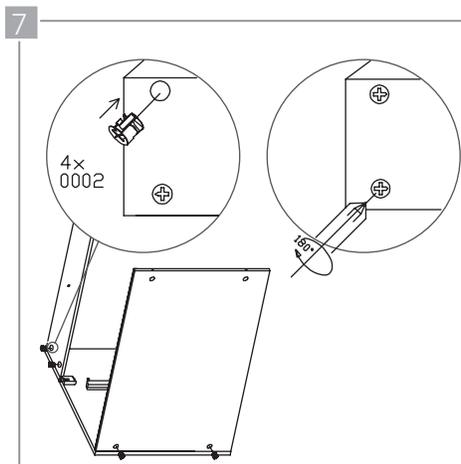
Fije el panel lateral (C) a las piezas (D), y (E) insertando los tensores (0002) tal como se muestra en la imagen. Ajustelos girando con un tornillo de estría  $\frac{1}{4}$  de vuelta. Repita los pasos 6 y 7 para ubicar el segundo panel lateral (C).
