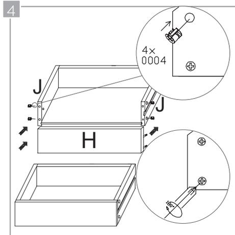
Inserte los salientes de los tornillos planos en los orificios que encontrará en los paneles laterales del cajón interior (J). Verifique que el acanalado interno coincide. Ajuste insertando 4 tensores (0002) en los orificios correspondientes y gírelos  $\frac{1}{4}$  de vuelta con un tornillo de pala.
