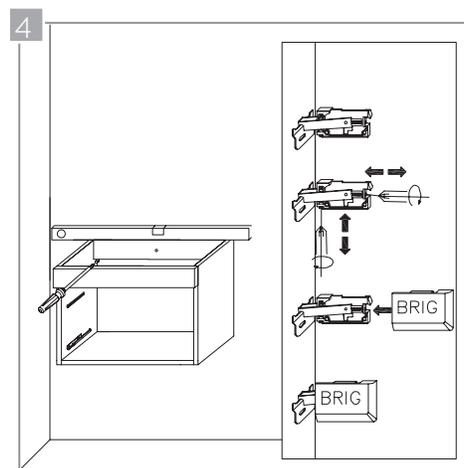
Ubique el mueble en la pared fijando las muescas de las abrazaderas (0008) en la saliente de los anclajes de pared (0011). Ajuste girando los tornillos que encontrará en la parte posterior de las abrazaderas, y corrija la inclinación lateral con la ayuda de un nivel, girando los tornillos que encontrará en el punto indicado en la gráfica.
