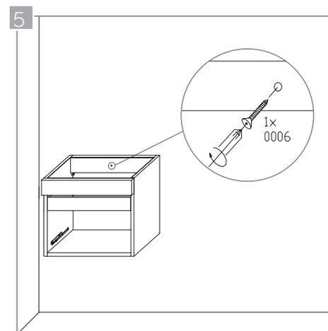
Refuerce la unión a la pared con un tornillo de 50 mm. (0006) en el orificio central del panel posterior del mueble (D). Este debe atravesar el panel e insertarse en el chazo plástico ubicado en la pared previamente.
