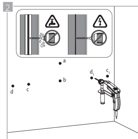
Utilizando un taladro y una broca de tungsteno, perfora la pared en los puntos a, c, d, c<sub>1</sub> y d<sub>1</sub>, e inserte los chazos plásticos suministrados en dichos orificios hasta que queden a tope. Tenga cuidado de no perforar tuberías de agua ni conductos eléctricos o de gas.
