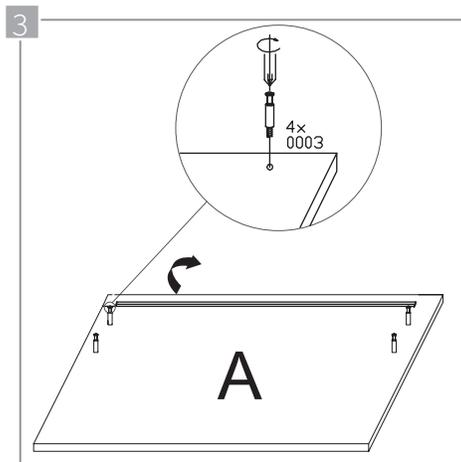
Ubique el panel frontal del cajón exterior (A) en una superficie plana y ajuste 4 tornillos planos de 25 mm. (0003) en los sitios indicados. Inserte las salientes de estos tornillos en los orificios que encontrará en los cantos de los paneles laterales del cajón exterior (F).
