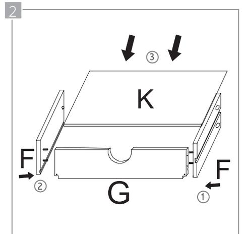
Inserte los salientes de los tabiques de madera en los orificios que encontrará en los cantos del panel posterior del cajón exterior (G). Verifique que el acanalado de los tres paneles coincide y deslice el fondo del cajón exterior (K) a través de ellos. No utilice pegamento en ninguna de las uniones.
