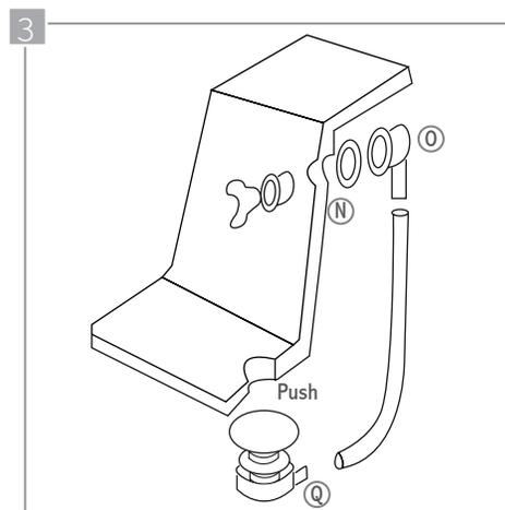
3 Finalice la instalación del acople del rebosadero y el sifón de acuerdo al gráfico. Antes de hacer el ajuste final, verifique que el orificio del sifón y el conducto del rebosadero están correctamente alineados, y refuerce con silicona anti hongos en los puntos indicados.
