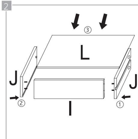
Inserte los salientes de los tabiques de madera en los orificios que encontrará en los cantos del panel frontal del cajón interior (I). Verifique que el acanalado interno de los tres paneles esté alineado, y deslice el fondo del cajón interior (L) a lo largo de él.
